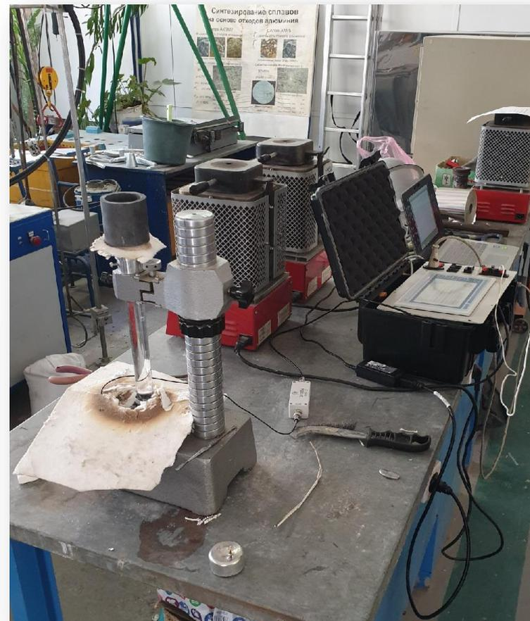
АКУСТИКО-ЭМИССИОННАЯ УСТАНОВКА ПРОГНОЗИРОВАНИЯ РАЗМЕРА ЗЕРНА АЛЮМИНИЕВОГО СПЛАВА В ПРОЦЕССЕ ЛИТЬЯ
